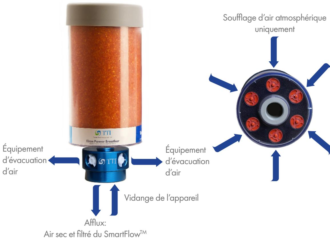
\* Les Titan SmarFlow PowerBreathers (Titan-XXXX-SF) se composent de tous les clapets anti-retour positionnés vers l'intérieur pour inhaler exclusivement de l'atmosphère, doivent donc être utilisés avec le Titan-SF-A1 (1" FNPT) ou Titan-SF-A2 (2" FNPT) Adaptateurs SmarFlow pour exhaler tout l'air du système.
