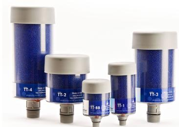
Ce filtre d'aération apporte une réelle amélioration par rapport aux filtres dépoussiéreur habituels et reniflards des fabricants d'équipements. Notre design unique à double média filtrant en fibre de verre permet une filtration absolue à 1 micron et retient efficacement la saleté et ce avec une faible perte de charge. Le power Gel, leader de l'industrie, offre une capacité de rétention d'humidité de près de 20 % supérieure à ses principaux concurrents.
